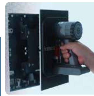
第四步，用力将模组沿垂直模组平面向上垂直拔出
